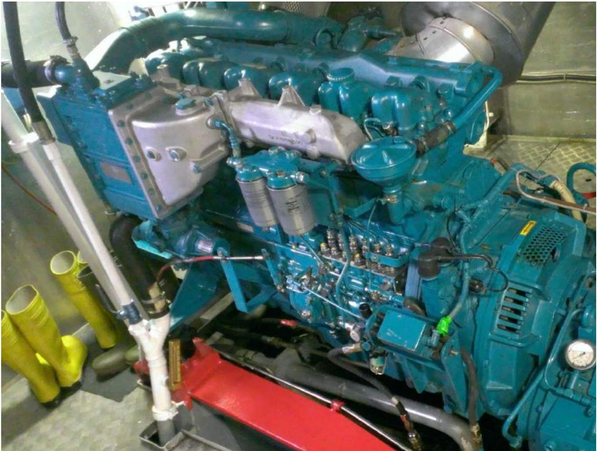
Abbildung 1: Antriebsmotor steuerbordseitig MAN D2866 LXE43
